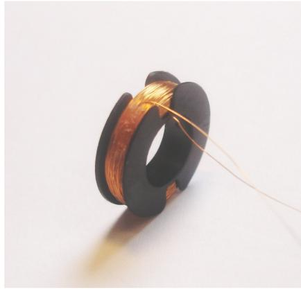
*Abbildung 5: Spulenkörper fertig bewickelt*
