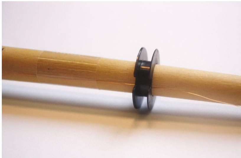
*Abbildung 4: Wickelvorrichtung*
