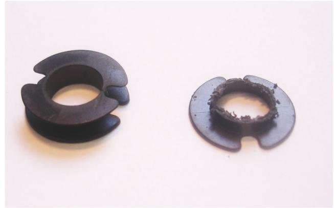
*Abbildung 3: Spulenkörper, zersägt*
