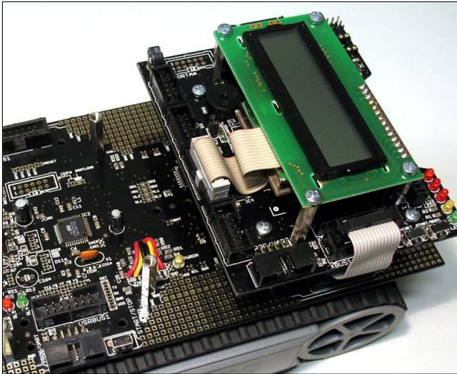
Wir empfehlen das RP6 CCPRO M128 auf dem hinteren Erweiterungsstapel auf dem Roboter zu montieren. Dann sind auch beide Programmieranschlüsse auf der gleichen Seite des Roboters zugänglich. Vorne können Sie das bereits im Lieferumfang des Roboters enthaltene Experimentiermodul anbringen (s. Foto unten für eine Beispielkonfiguration).
