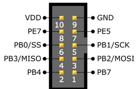
PB1, PB2 und PB3 können NICHT als normale I/O Pins verwendet werden, auf dem Modul ist hier bereits ein Schieberegister angeschlossen um das LCD und einige der LEDs anzusteuern (wenn man diese Komponenten nicht benötigt, wäre allerdings auch eine Nutzung als normale I/O Pins denkbar. Bitte den Schaltplan beachten!). PB7 ist zusätzlich auf einem der Servo Anschlüsse verfügbar, kann also nur entweder für einen Servo ODER als Chipselect Leitung verwendet werden.
