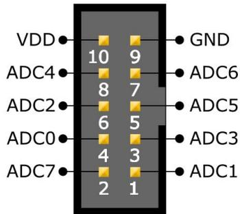
Die 8 freien ADC Kanäle (die natürlich auch als I/O Pins verwendbar sind) sind zusammen mit der Betriebsspannung am 10 poligen ADC Stecker verfügbar.
