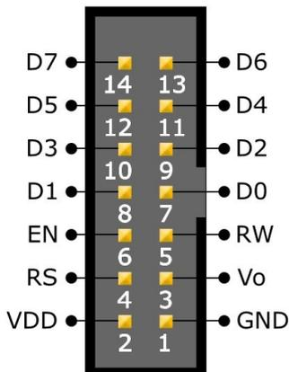
Wenn Sie nicht das Standard LCD einsetzen möchten, können Sie anhand der nebenstehenden Anschlussbelegung ein eigenes 14 poliges Kabel für das LCD zusammenbauen.
