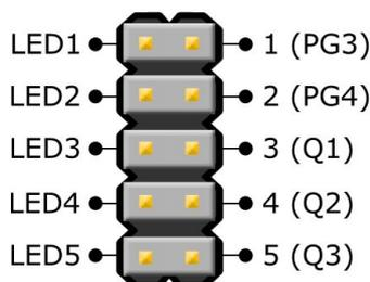
Die LEDs lassen sich per Jumper deaktivieren. An diesem Jumperfeld kann man dann direkt über Steckverbinder o.ä. die I/Os bzw. Schaltausgänge verwenden. LED1 und 2 sind mit den I/O Ports PG3 und PG4 verbunden, LED3, 4 und 5 nur mit reinen Ausgängen des Schieberegisters an dem auch das LCD angeschlossen ist.
