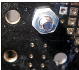
Dann können Sie die vier 25mm M3 Distanzbolzen nacheinander mit M3 Muttern in den Befestigungslöchern im Mainboard festzuschrauben wie auf dem Foto gezeigt.
