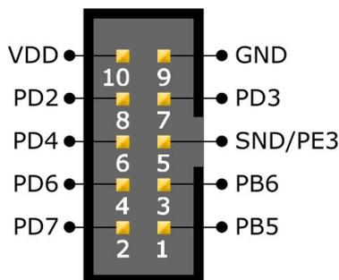
Am „I/O“ Wannenstecker sind einige der freien I/O Pins und die 5V Betriebsspannung verfügbar.
