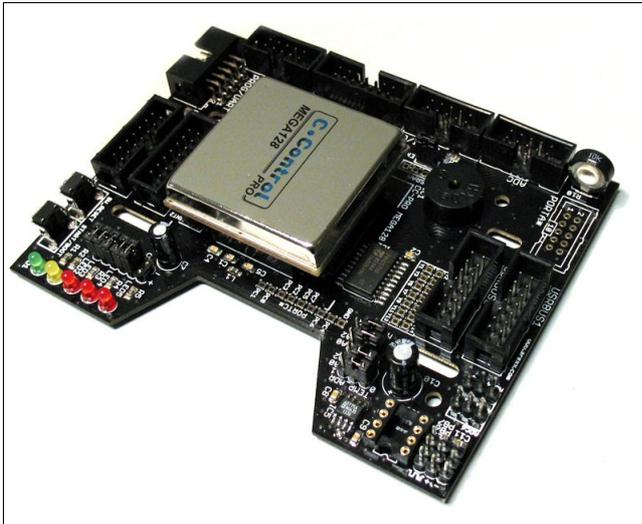
Zunächst müssen Sie die CCPRO MEGA128 Unit richtig auf das Erweiterungsmodul aufstecken. Bitte fassen Sie zur Sicherheit vor dem Hantieren mit dem Modul einen geerdeten Gegenstand an, um sich zu entladen. Beispielsweise ein blankes Rohr eines Heizkörpers oder ein Metallteil eines geerdeten PC Gehäuses (mit 3 poligem Netzstecker!).
