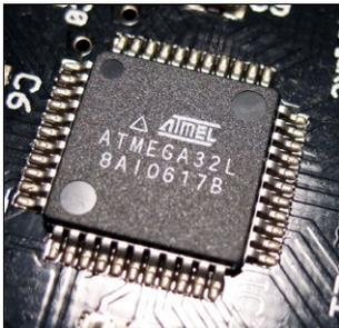
Wie man auf dem Blockdiagramm leicht erkennen kann, ist das zentrale Element des Roboters der ATMEGA32 8-Bit Mikrocontroller von ATMEL (s. Abb.).
