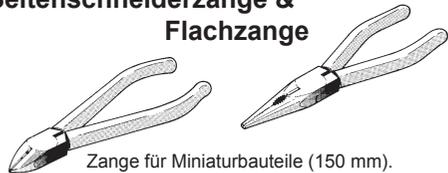
Zange für Miniaturbauteile (150 mm).
