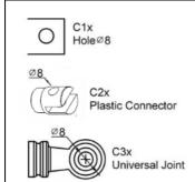
Für die Kolbenstange stehen mehrere End-Connectoren zur Verfügung. C1x - ist die Standard-Auslieferung
