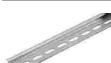
Art-Nr.: 210-115 Stahltragschiene; 35 x 7,5 mm; 1 mm dick; 2 m lang; gelocht; entsprechend EN 60715; Lochbreite 18 mm; Lochabstand 25 mm
