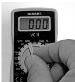
Bild 21: Vor jeder Messung ist das Instrument zuerst auf den maximalen Messbereich zu schalten. Bei diesem Gerät beträgt er im Gleichspannungsbereich 250 V.
