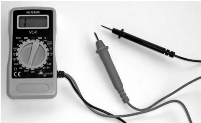
Bild 51: Bei auseinandergehaltenen Strippen ist der Widerstand unendlich groß, was durch „1-“ angezeigt wird. Dies würde einen Kabelbruch oder nicht gefundene Adern bei einem mehradrigen Kabel bedeuten.
