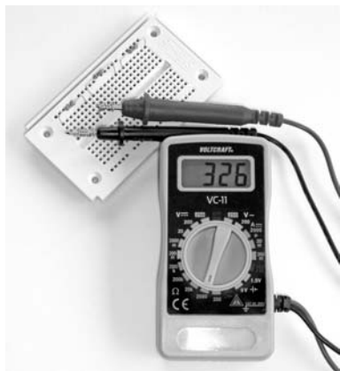
Bild 27: Bei korrekter Messwerteinstellung entpuppt sich der zweite, ursprünglich als 1-kΩ-Widerstand gemessene Widerstand, als 330-Ω-Widerstand.
