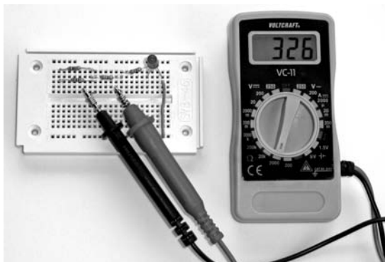
Bild 59: Das Messen einzelner Widerstände in einer Schaltung funktioniert nur richtig, wenn zu ihnen keine anderen Bauteile parallel geschaltet sind.
