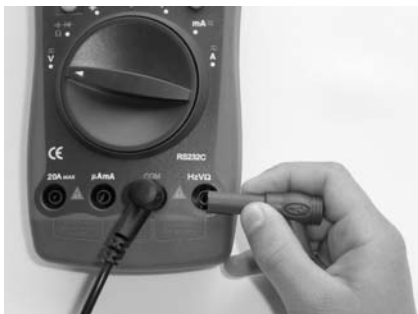
Bild 19: Sollen Spannungs- und Widerstandsmessungen vorgenommen werden, ist bei diesem Modell die rote Messleitung an die rechte Buchse HzVΩ anzuschließen. Zum Messen kleiner Ströme müsste sie an die Buchse µA mA angedockt werden.
