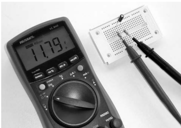
Bild 35: Am Multimeter ist der Kapazitätsmessbereich einzustellen. Es dauert einige Sekunden, bis der Messwert abgelesen werden kann.
