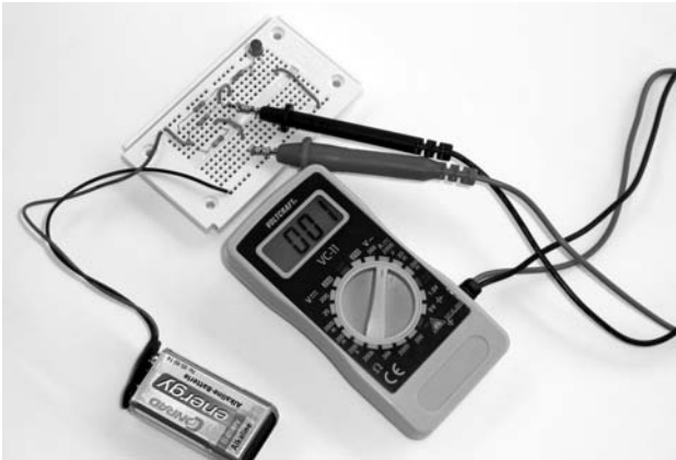
Bild 64: Durch den sehr hohen 2,2\text{-M}\Omega -Widerstand fließt kaum Strom. Der gemessene Wert von 1 mA ist jedoch nur auf einen hohen Messfehler begründet. Tatsächlich ist er wesentlich geringer.
