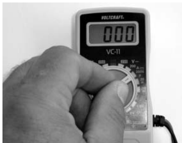
Bild 20: Es ist auf die Wahl der richtigen Messgröße (z. B. „Gleichstrom“, wenn Gleichströme gemessen werden sollen) zu achten.
