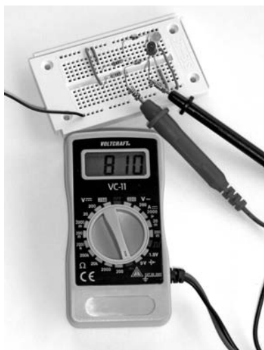
Bild 72: Eine zweite Möglichkeit bietet die Diodentest-Funktion des Voltcraft VC-11. Wird ein Messwert angezeigt, wird die Diode in Durchgangsrichtung gemessen.
