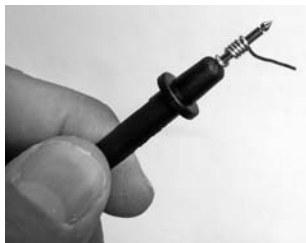
Bild 23: Rund 7 cm lange blanke Drahtstücke werden um die Prüfspitzen gewickelt.
