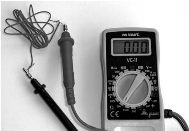
Bild 52: Ermittlung des Leitungsdurchgangs an einem Kabel.
