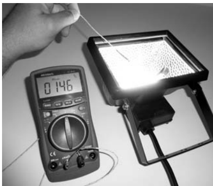
Bild 80: Hier wird die Lufttemperatur in der Nähe eines Halogenstrahlers ermittelt. Nur die Messspitze des Draht-Temperaturfühlers darf hohen Temperaturen ausgesetzt sein.
