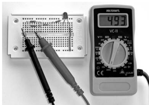
Bild 57: An den beiden in der Schaltung parallel zueinander eingebauten 1\text{-k}\Omega -Widerständen kann nur der Gesamtwiderstand von hier 493 \Omega gemessen werden.
