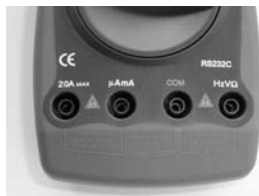
Bild 17: Die meisten Multimeter sind mit 3-4 Buchsen ausgestattet, an die die beiden Messstrippen, je nach auszuführenden Messungen, anzuschließen sind.
