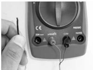
Bild 79: Die schwarze Strippe ist mit der COM-Buchse des Instruments zu verbinden. Die rote ist an der Buchse \Omega mA A^{\circ}C anzuschließen.
