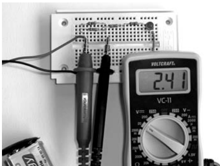
Bild 55: Egal, ob man den Spannungsabfall an jedem einzelnen der beiden parallel geschalteten Widerstände oder von ihnen gemeinsam misst - er ist stets gleich groß.
