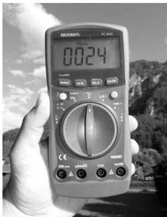
Bild 77: Sobald Sie am Multimeter den Temperaturmessbereich eingestellt haben, können Sie die Umgebungstemperatur messen.
