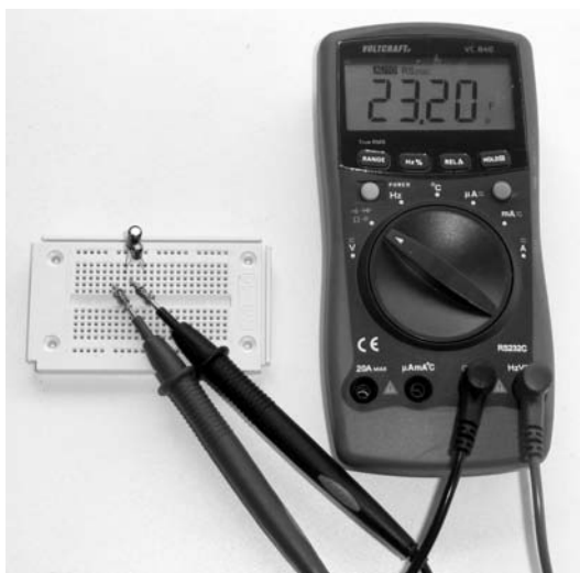
Bild 41: Bei zwei parallel geschalteten 10- \mu F-Kondensatoren messen Sie die Summe der Einzelkapazitäten der beiden Kondensatoren.
