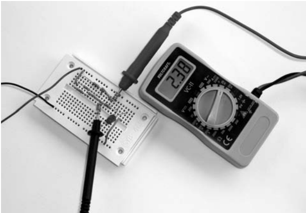
Bild 65: Durch die beiden 330\text{-}\Omega -Widerstände fließen je rund 2,4 mA.
