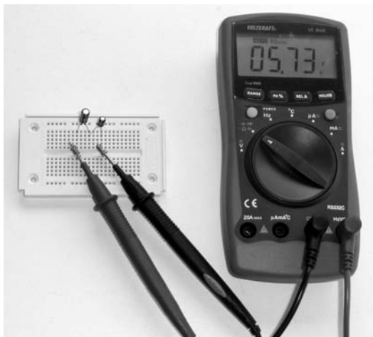
Bild 38: Bei zwei in Serie geschalteten 10\text{-}\mu\text{F} -Kondensatoren messen Sie die Hälfte der Einzelkapazität eines Kondensators.
