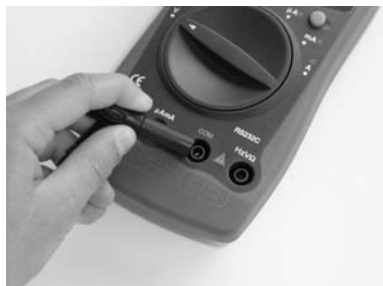
Bild 18: Die schwarze Strippe ist an COM anzuschließen. Sie entspricht der Rückleitung (dem Minuspol).
