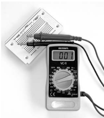
Bild 25: Im höchsten einstellbaren Messbereich sind die Messergebnisse noch recht ungenau.
