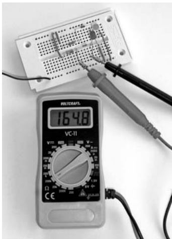
Bild 70: Hier wird die Diode in Sperrrichtung betrieben. Der ermittelte Widerstand ist unendlich groß.
