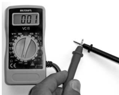
Bild 50: Werden die beiden Strippen zusammengehalten, zeigt das Multimeter bei eingestellter Widerstandsmessung 0,0 \Omega oder 0,01 \Omega . Somit ist Leitungsdurchgang gegeben, dieser hat nämlich annähernd keinen Widerstand.
