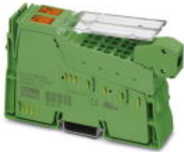
Inline-RS 485/422-Funktionsklemme, komplett mit Zubehör (Anschlussstecker und Beschriftungsfeld), 1 serieller Ein- und Ausgabekanal
