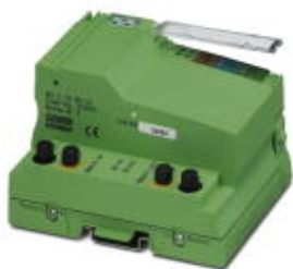
INTERBUS-Buskoppler, mit Lichtwellenleiter-Anschluss, 24 V DC, komplett mit Zubehör (Anschlussstecker und Beschriftungsfeld)
