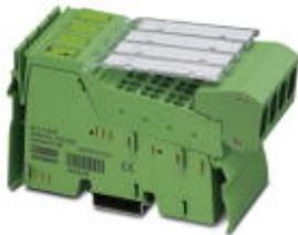
Inline-Analog-Eingabeklemme, komplett mit Zubehör (Anschlussstecker und Beschriftungsfeld), 8 Eingänge, 0-20 mA, 4-20 mA, 0-40 mA,  $\pm 20$  mA,  $\pm 40$  mA, 2-, 3-Leiter-Anschluss technik
