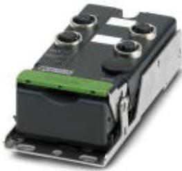
AS-i-Digital Eingabegerät, AB-Slave, 4 digitale Eingänge, 24 V DC, 2-, 3- und 4-Leiter-Anschlussstechnik, Schutzart IP67
