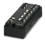
Der Ethernet-Buskoppler eröffnet einen Lokalbus für bis zu 16 Teilnehmer. Weitere Funktionen: 10 Mbit/s und 100 MBit/s, Autonegotiation, Autocrossover, 8 digitale Eingänge, kanalgenaue Diagnose, Kurzschluss- und Überlastschutz, M12-Schnellanschlusstechnik
