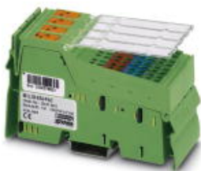
S0-Zählerklemme, 8 Zählengänge/Digitaleingänge, Erfassen von Zählimpulsen von Pulsgebern mit S0-Schnittstelle gemäß DIN 43864 sowie von Pulsgebern der Klasse A gemäß IEC 62053-31
