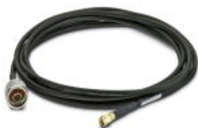
Antennenkabel, 0,5 m Länge; N (male) -> RSMA (male), Impedanz 50 Ohm
