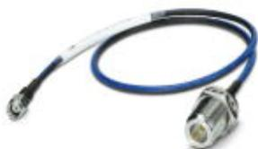
Adapterkabel, Pigtail 50 cm, N (female) -> RSMA (male), Einfügedämpfung 0,75 dB bei 2,4 GHz; 1,25 dB bei 5 GHz, Impedanz 50 Ohm;
