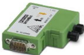
INTERBUS-Lichtwellenleiter-Umsetzer zur Umsetzung der Remote-OUT-Schnittstelle auf Lichtwellenleiter, Ausregeln der optischen Sendeleistung, Übertragungsgeschwindigkeit von 2 MBaud, LWL-Abgang links
