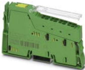
Inline-Analog-Ausgabeklemme, komplett mit Zubehör (Anschlussstecker und Beschriftungsfeld), 2 Ausgänge, 0-20 mA, 4-20 mA, \pm 20 mA, 0-10 V, \pm 10 V, 2-Leiter-Anschlussstechnik
