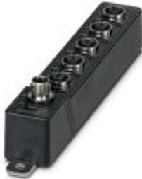
Ethernet-Switch, 5 frontseitige Ethernet-Ports im M12-Format, automatische Erkennung der Datenübertragungsrate von 10 oder 100 MBit/s, Kopplung von Netzsegmenten mit unterschiedlichen Bitraten, Autocrossing-Funktion, Schutzart IP67
