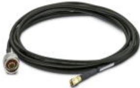
Antennenkabel, 3 m Länge; N (male) -> RSMA (male), Impedanz 50 Ohm
