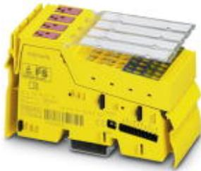
Sicherheitsgerichtetes digitales Ausgangsmodul, Schutzart IP20, für das INTERBUS-Safety- und das PROFIsafe-System.. Das Modul verfügt über 4 sichere digitale Ausgänge bei zweikanaliger Belegung oder 8 sichere digitale Ausgänge bei einkanaliger Belegung
