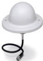
Rundstrahlantenne mit Vandalenschutz, 2,4 GHz, Gewinn 3 dBi, Schutzart IP55, Kabellänge 1,5 m, Anschluss RSMA (male), Öffnungswinkel h/v 360°/85°. Für die Wandmontage ist entsprechendes Montagematerial verfügbar.
