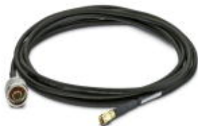
Antennenkabel, 1 m Länge; N (male) -> RSMA (male), Impedanz 50 Ohm
