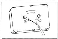
1. Verbinden Sie die Solarzelle und die Kabel mit Schrauben und Muttern.
