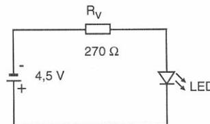
LED wird in Sperrrichtung angeschlossen und leuchtet demzufolge nicht. (Kathode an "+")
