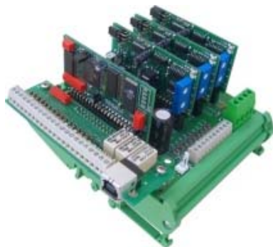
Das Bild zeigt das BASIS-Modul komplett ausgebaut mit Hutschienen-Adapter für Schaltschrankbau
