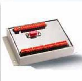
■ Vergossener Millenium 3 mit abziehbaren Anschlusssteckern
