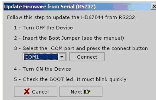
Gehen Sie hierbei wie in Kapitel 2.1 beschrieben vor. Wählen Sie in dem Drop-Down-Menü Ihre Schnittstelle aus und betätigen Sie den Button „Connect“, um diese zu initialisieren. Danach gehen Sie mit „Next“ einen Schritt weiter.
