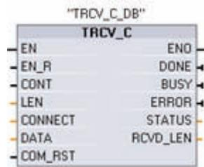
TRCV\_C stellt eine TCP- oder ISO-on-TCP-Verbindung zu einer CPU her, empfängt Daten und kann die Verbindung auch wieder beenden. Nach dem Einrichten und Aufbauen der Verbindung wird diese automatisch von der CPU gehalten und überwacht. Die Operation TRCV\_C verbindet die Funktionen von TCON, TDISCON und TRCV.
