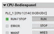
Die CPU verfügt nicht über einen physischen Schalter zum Ändern des Betriebszustands (STOP bzw. RUN). Zu diesem Zweck können Sie das CPU-Bedienpanel in den "Online-Tools" von STEP 7 Basic verwenden.
