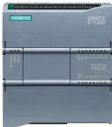
Die CPU liest die physischen Eingänge unmittelbar vor der Ausführung des Anwenderprogramms und speichert die Eingangswerte im Prozessabbild der Eingänge. Dadurch wird sichergestellt, dass diese Werte während der Ausführung der Anwenderoperationen konsistent bleiben.
