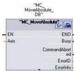
MC\_MoveAbsolute startet die Bewegung zu einer absoluten Position. Der Auftrag ist beendet, wenn die Zielposition erreicht ist.
