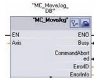
MC\_MoveJog führt den Tippbetrieb zu Test- und Anlaufzwecken aus.
