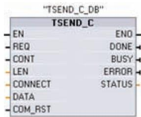
TSEND\_C stellt eine TCP- oder ISO-on-TCP-Verbindung zu einem Partner her, sendet Daten und kann die Verbindung auch wieder beenden. Nach dem Einrichten und Aufbauen der Verbindung wird diese automatisch von der CPU gehalten und überwacht. TSEND\_C verbindet die Funktionen von TCON, TDISCON und TSEND.
