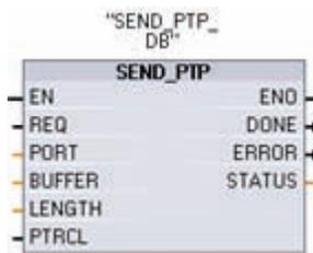
Die Operationen SEND\_PTP, RCV\_PTP und RCV\_RST steuern die PtP-Kommunikation:
