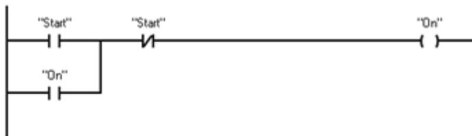
Die Elemente eines Schaltplans, wie Öffnerkontakte, Schließerkontakte und Spulen, werden zu Netzwerken verknüpft.
