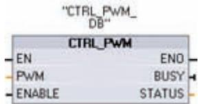
Wenn Sie die Operation CTRL\_PWM in den Programmiereditor einfügen, wird ein DB zugewiesen. Die Operation CTRL\_PWM speichert Parameterdaten in einem Datenbaustein (DB). Die Parameter des Datenbausteins werden von der Operation CTRL\_PWM bestimmt.
