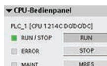
Mit der Schaltfläche auf dem Bedienpanel ändern Sie den Betriebszustand (STOP bzw. RUN). Außerdem enthält das Bedienpanel eine Schaltfläche MRES zum Umräumen des Speichers. Der aktuelle Betriebszustand der CPU wird durch die Farbe der RUN/STOP-Anzeige angegeben. Gelb steht für den Betriebszustand STOP, Grün für RUN.)
