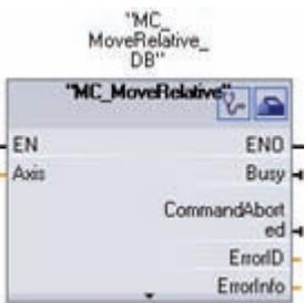
MC\_MoveRelative startet eine Positionierbewegung relativ zur Startposition.
