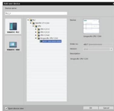
Zum Einfügen einer "nicht spezifizierten CPU" verwenden Sie eine der folgenden Optionen:
