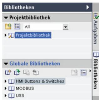
Jedem Projekt ist eine Projektbibliothek zugeordnet, in der die während des Projekts mehrfach verwendeten Objekte abgelegt werden. Diese Projektbibliothek ist Teil des Projekts. Durch Öffnen oder Schließen des Projekts wird auch die Projektbibliothek geöffnet oder geschlossen. Durch Speichern des Projekts werden Änderungen in der Projektbibliothek gespeichert.
