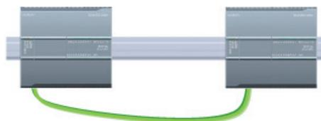
Bei direkter Verbindung zwischen zwei CPUs:
