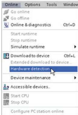
Wenn eine Verbindung zu einer CPU besteht, können Sie die Konfiguration dieser CPU einschließlich evtl. vorhandener Module aus dem Gerät in Ihr Projekt laden. Legen Sie dazu einfach ein neues Projekt an und wählen Sie anstelle einer bestimmten CPU die "nicht spezifizierte CPU". (Sie können auch die Gerätekonfiguration ganz umgehen, indem Sie unter "Erste Schritte" auf "Ein PLC-Programm erstellen" klicken. STEP 7 Basic legt dann automatisch eine nicht spezifizierte CPU an.)
