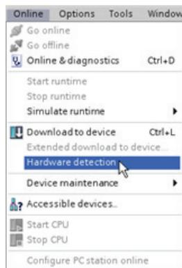
Nach dem Anlegen der nicht spezifizierten CPU können Sie die Hardwarekonfiguration von der Online-CPU laden.
