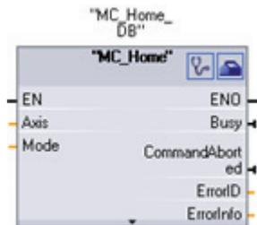
MC\_Home stellt die Beziehung zwischen dem Achsensteuerungsprogramm und dem mechanischen Positionierungssystem der Achse her.
