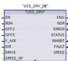
Die Operation USS\_DRV tauscht Daten mit dem Antrieb aus, indem Anfragemeldungen erzeugt und die Antwortmeldungen des Antriebs ausgewertet werden. Alle mit einem USS-Netzwerk und CM verbundenen USS-Operationen müssen denselben Instanz-DB verwenden.
