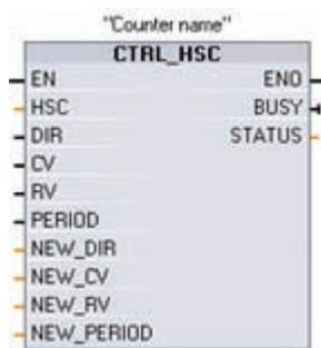
Die Operation CTRL\_HSC steuert die schnellen Zähler zum Zählen von Ereignissen, die schneller als der CPU-Zyklus auftreten.
