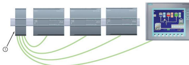
Die CPU nutzt die Anwendungsprotokolle TCP (Transport Connection Protocol) und ISO Transport over TCP (RFC 1006). Beim Konfigurieren einer Verbindung mit einer CPU für ISO-over-TCP dürfen Sie in der TSAP-Erweiterung für die passiven Kommunikationsteilnehmer nur ASCII-Zeichen verwenden.
