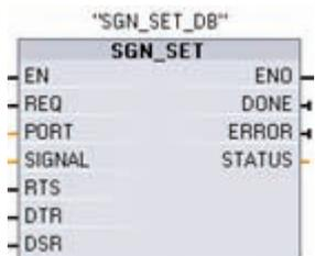
Die Operationen SGN\_SET und SGN\_GET sind nur für das RS232-CM-Modul gültig. Mit diesen Operationen lesen oder setzen Sie die RS232-Kommunikationssignale.
