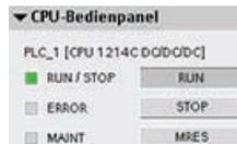
Der aktuelle Betriebszustand der CPU wird durch die Farbe der RUN/STOP-Anzeige angegeben: Gelb steht für den Betriebszustand STOP, Grün für RUN.
