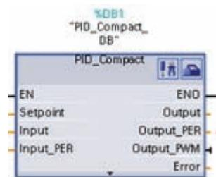
Führen Sie die Operation PID\_Compact in einem konstanten Zeitintervall der Abtastzeit aus (nach Möglichkeit in einem Weckalarm-OB).
