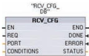
Die dynamischen Konfigurationsänderungen werden in der CPU nicht dauerhaft gespeichert. Nach dem Einschalten wird die statische Anfangskonfiguration aus der Gerätekonfiguration verwendet.
