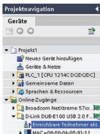
Um Ihr Projekt (einschließlich Anwenderprogramm, Gerätekonfiguration und IP-Adresse) zu laden, stellen Sie eine Onlineverbindung zu einer CPU her. Verwenden Sie zum Herstellen der Verbindung zu einer Online-CPU den Ordner "Online-Zugänge".
