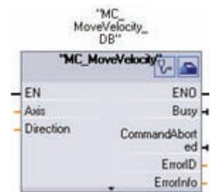
MC\_MoveVelocity bewirkt, dass sich die Achse mit der angegebenen Geschwindigkeit bewegt.
