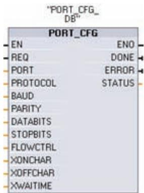
Mit Hilfe der Operationen PORT\_CFG, SEND\_CFG und RCV\_CFG können Sie die Konfiguration aus Ihrem Anwenderprogramm heraus ändern.
