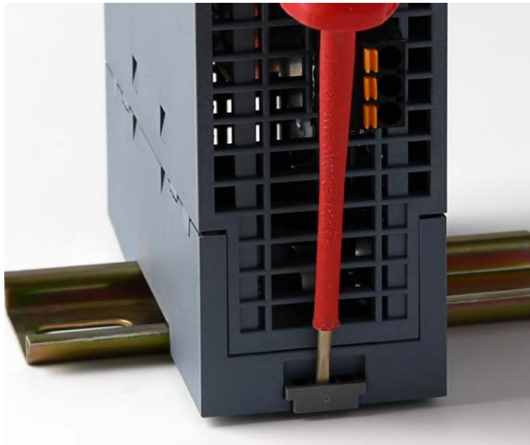
Bild 4-3 Demontage des XB-000
