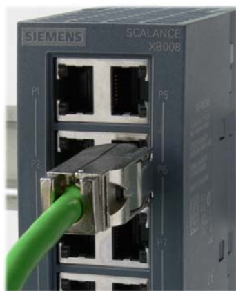
Bild 4-9 Stecken des IE FC RJ45 Plug 180
