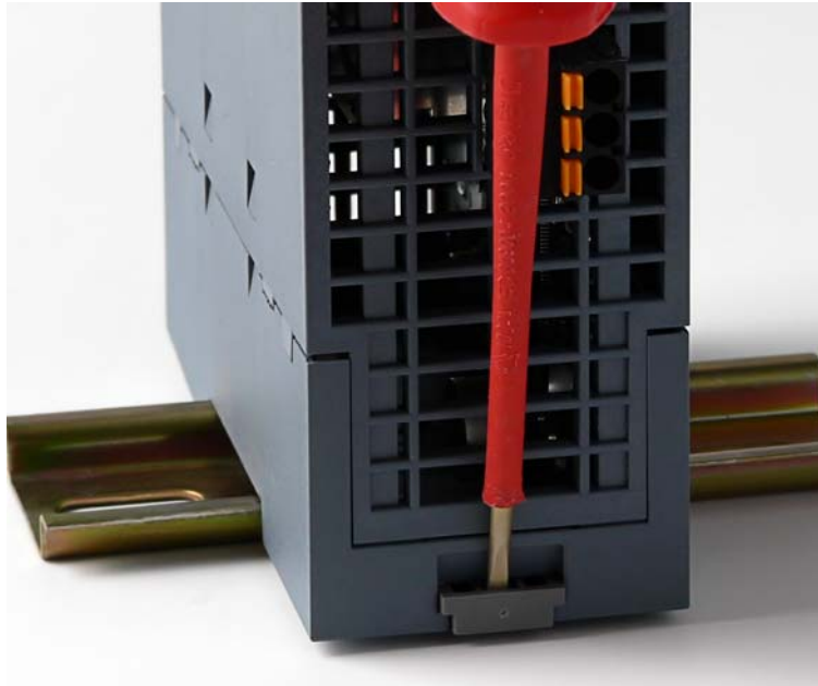
Bild 4-3 Demontage des XB-000
