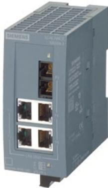
SCALANCE XB004-1LD unmanaged Industrial Ethernet Switch für 10/100 Mbit/s; zum Aufbau von kleinen Stern- und Linienstrukturen; LED-Diagnose, IP20, AC/DC 24V Spannungsversorgung, mit 4x 10/100 Mbit/s Twisted Pair Ports mit RJ45-Buchsen; 1 x 100 Mbit/s Single-Mode Glas LWL-Port mit SC-Buchse; Handbuch als Download verfügbar .
