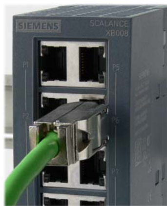
Bild 4-9 Stecken des IE FC RJ45 Plug 180
