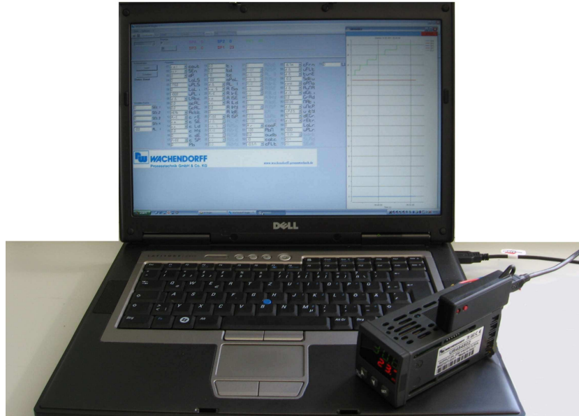
Bild 1: Wachendorff-Regler Software mit Programmiermodul
