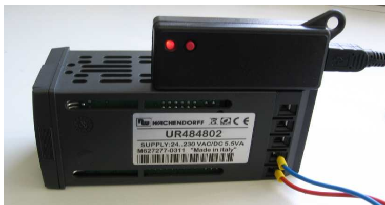
Bild 3: Installation Programmiermodul im UR4848xx
