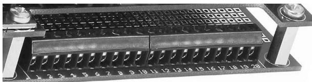
Zur Montage stecken Sie das Anwender-Modul von unten auf den Unit-Bus Steckverbinder des Einbau-Moduls und befestigen es mit dem beiliegenden Montagesatz.
