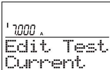
Bild 29: Vorgabe des Stromimpulses bei der Akku-Ri-Messfunktion
