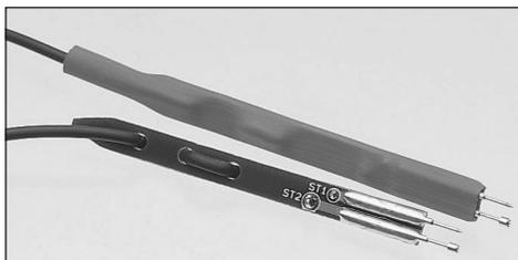
**Bild 6: Spezial-Messleitungen mit federnd gelagerten Messspitzen**
