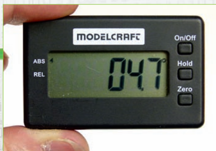
Die Displayanzeige passt sich der Benutzungsrichtung der Elektronik an.
