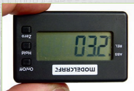
Die Displayanzeige passt sich der Benutzungsrichtung der Elektronik an.
