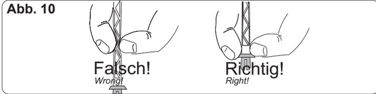
Lassen Sie beim Anschließen der Kabel unter dem Signal eine Schleife von ca. 2 – 3 cm Länge, damit Sie das Signal bei eventuellen Arbeiten aus der Montagebohrung ziehen können.
