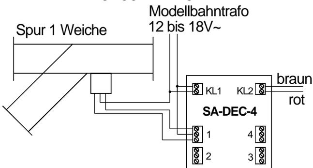
Der große Vorteil ist dabei, dass die stromfressenden Antriebe den Digitalstromkreis nicht belasten und somit teurer Digitalstrom gespart wird.
