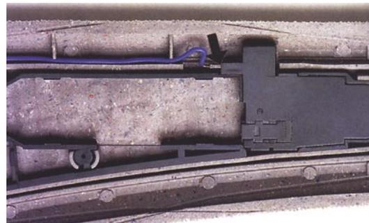
Die Roco-Line-Weichenbauformen ohne Bettung erfordern lediglich das parallele Verlegen und Einstecken von drei Leitungen in die sog. Schwellenbuchsen bzw. die Buchsen im Seitenantrieb entsprechend der Antriebsempfehlung im HO-Hauptkatalog.
