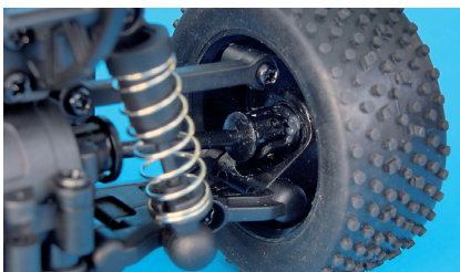
Die Kardan-Antriebswellen sind gefettet. Spur und Sturz sind fest vorgegeben
