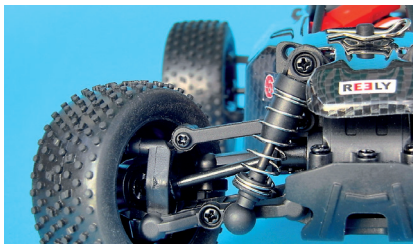
Vier identische Federbeine. Noppenreifen sorgen für den richtigen Grip
