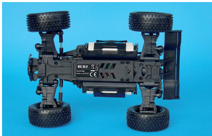
Die Elektronik ist gut geschützt. Die Querlenker vorn und hinten sind identisch
