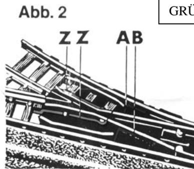
Achtung! Bei Verwendung von Schaumstoff-Gleisbettung diese im Bereich des roten Mitnehmers bzw. Handschalthebels ausschneiden (siehe Weichenunterseite).
