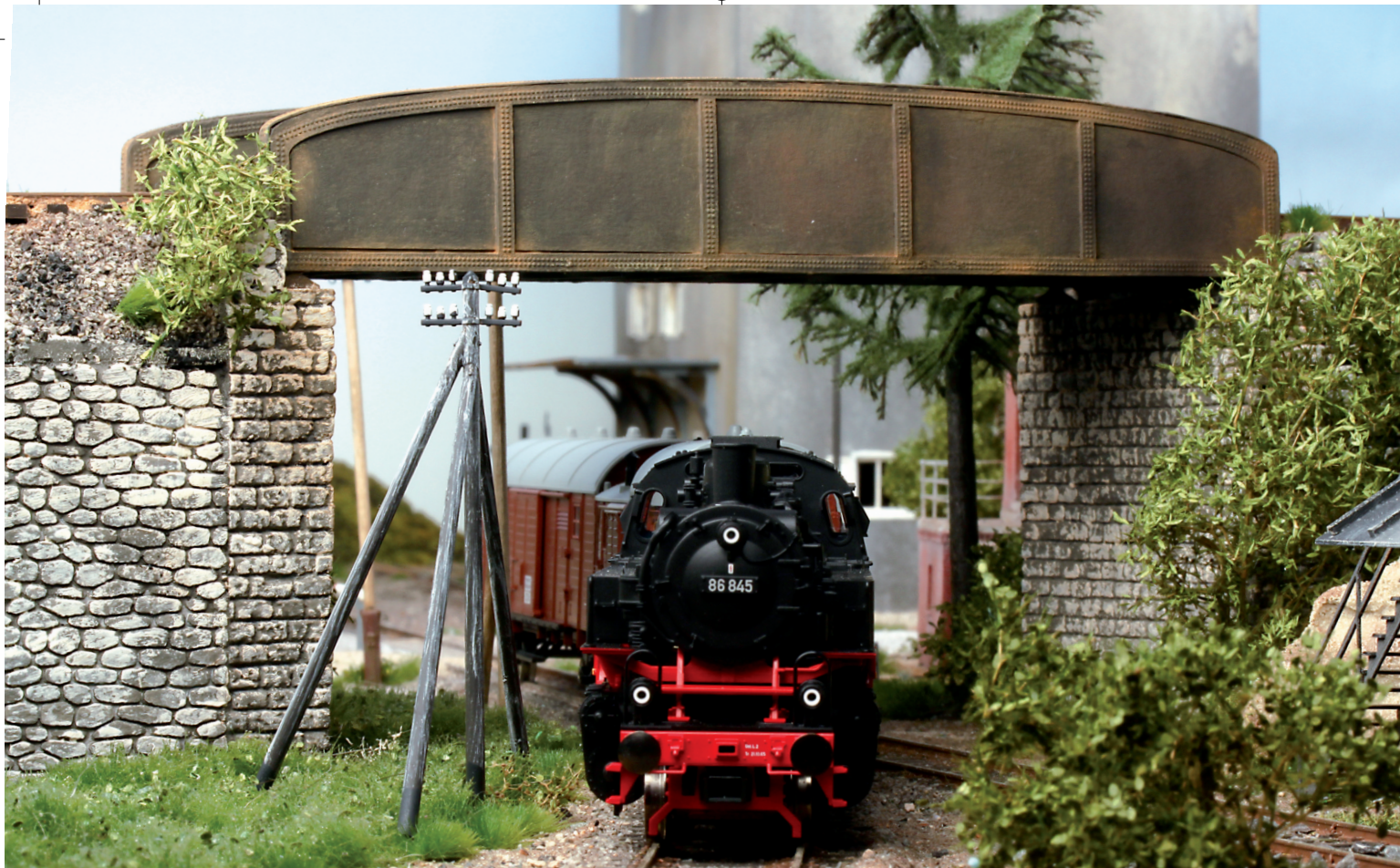
Einst an jeder Strecke zu finden: Telegrafenmasten. Im Bereich von Gleisbögen müssen die Masten mit einer zusätzlichen Abstützung versehen werden
