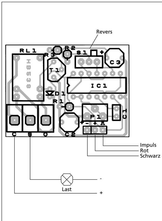
boten, sie muß Kerbe auf Kerbe eingesteckt werden. Dann sind nur noch Anschlußklemme, Mikroschalter und Relais nach Bestückungsplan einzusetzen. Zuletzt wird das IC in die Fassung gesteckt, wobei wieder auf die richtige Lage der Kerbe geachtet werden muß. Nach Abschluß der Lötarbeiten folgt eine gründliche Kontrolle der Bestückung und Lötarbeit.
