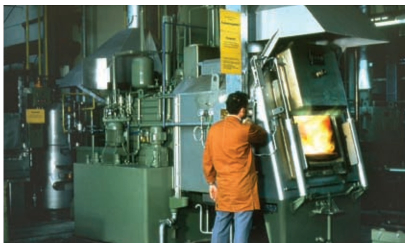
Bild 46: Automatisch gesteuerte Prozessgasanlage zum Härten unter Schutzgas
