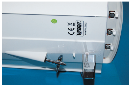
Kühlwassereinlass zwischen Ruder und Schiffspropeller
