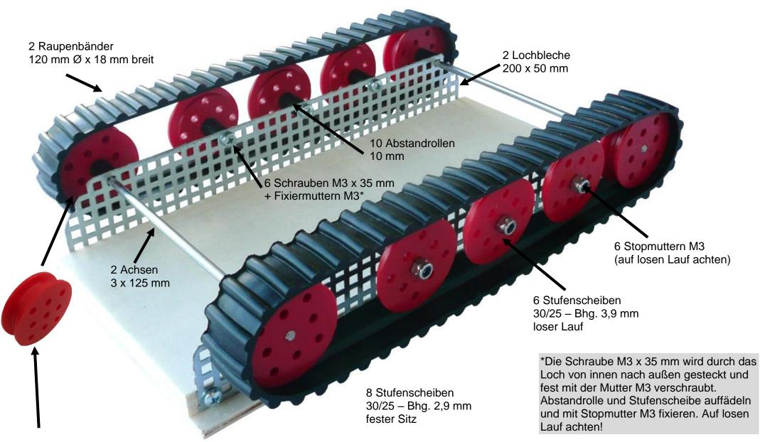
Die 8 Stufenscheiben 30/25 mm – Bhg. 2,9 mm sind gegen gesetzt als Paar auf die Achse zu drücken und dienen als Führungsrolle des Raupenbandes.
