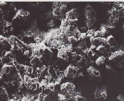
Nach 2 Jahren Laufzeit konnte durch anschließenden Einsatz des Megapulse die stark geschädigte Batterieplatte wieder teilweise regeneriert werden. Die Anfangs starke Kristallbildung (sog. Sulfatierung) konnte zum größten Teil in die ursprünglich schwammige Struktur zurückgebildet werden, wodurch die Batterie jetzt wieder in der Lage ist, Ladung aufzunehmen.
