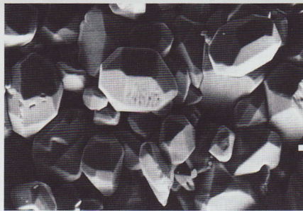
Batterie nach 24 Monaten Lagerung, ungeladen, ungepulst.
