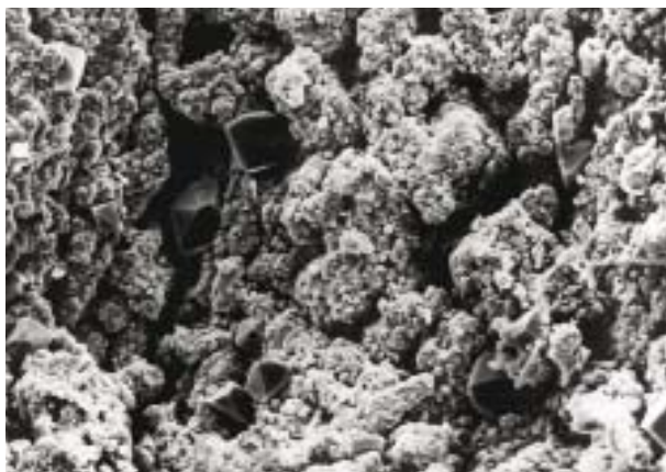
Plattenoberfläche nach 11 Monaten mit Pulsung. Diese Batterie kann noch die volle Ladung aufnehmen.
