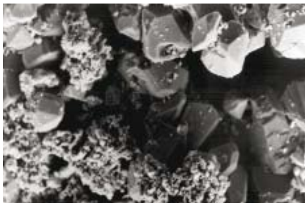
Sechs Monate alte Batterie ohne Pulser unter dem Elektronenmikroskop. Es sind bereits einige größere Kristalle erkennbar.
