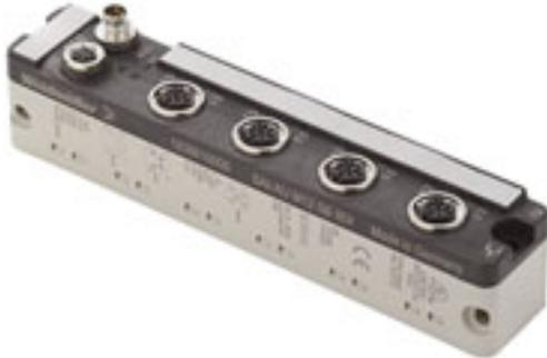
Der Trend von IP20 zu IP67 bzw. von Schaltschränken zu schaltschranklosen Maschinen findet seinen Höhepunkt in IP67 I/O-Slaves. Bei diesen Plug & Play-Lösungen wird auf das Anschließen von Einzelleitern komplett verzichtet. Dadurch entsteht eine hohe Zeitersparnis, und Fehler beim Anschließen einzelner Leiter kommen nicht mehr vor. IP67 Busmodule sind heute die modernste und Kosten sparendste Lösung für den Anschluss von Sensoren und Aktoren.
